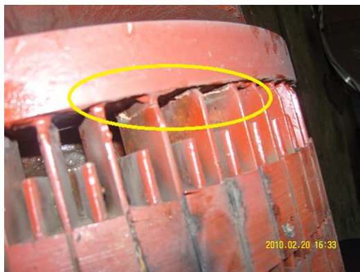
电动机转子多根断条，并发生扫堂
