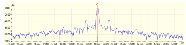
电流低频频谱-工频及极通过频率边带
